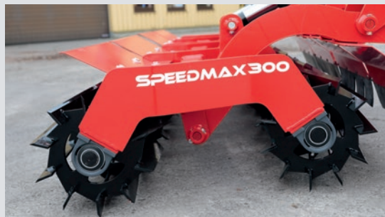
Boogiefahrwerk sorgt für Laufruhe auch bei unebenem Gelände
