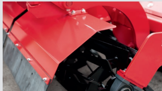
Schutzbleche schützen den Schlepper vor Steinschlagschäden
