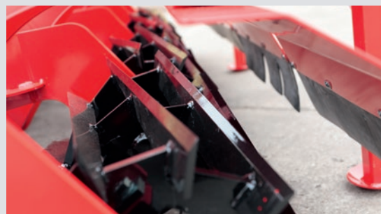
Enger Messerabstand sorgt für kurze Schnittlänge der Restpflanze
